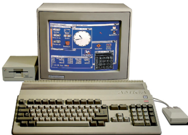
Abbildung 61: Commodore Amiga 500, 16-Bit-Computer (1987), hier komplett mit Amiga OS, einem farbigen Monitor, einer Computermouse, dem integrierten Keyboard sowie einem Floppy Disk Drive. Quelle: Wikipedia.
