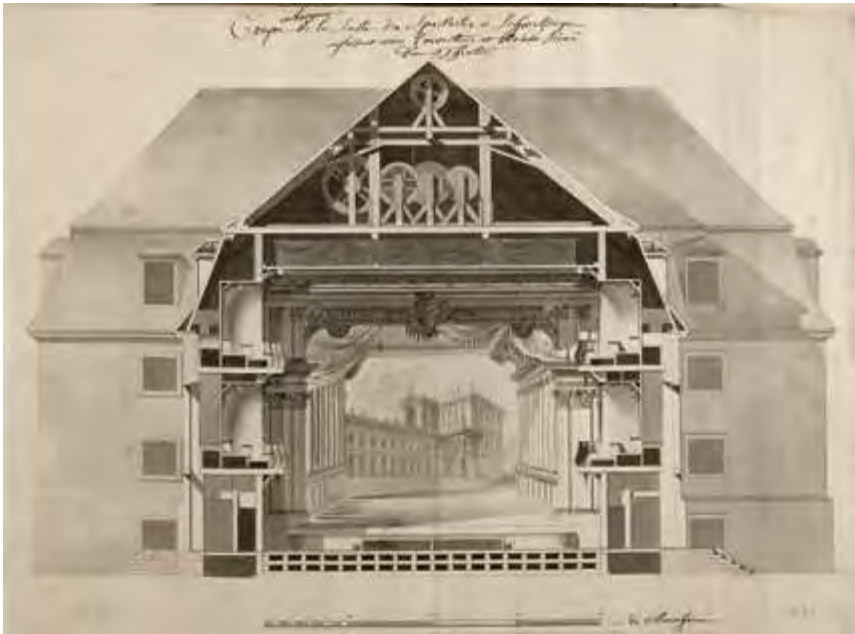
Abb. 15: Nicolas de Pigage: Schwetzingen, Theater, Querschnitt durch den Bühnen- raum, um 1755.
